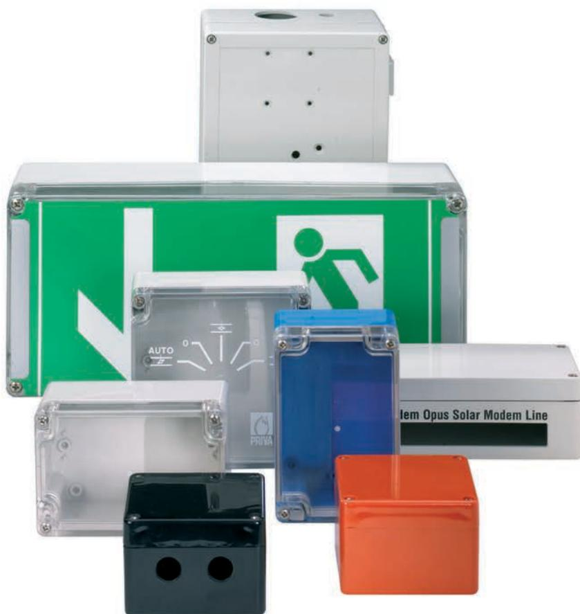
Le custodie in polycarbonato si prestano in modo eccellente all'inserimento di componenti elettronici ed elettrici. L'elevata resistenza ai raggi UV del materiale permette di utilizzare le custodie sia all'interno che all'esterno. Le nostre custodie MBM possono essere lavorate meccanicamente a specifica del cliente. Le custodie sono disponibili a scelta con coperchio grigio opaco o trasparente (K)
